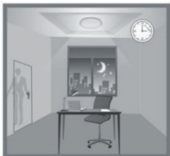
Efter en viss tid utan rörelse i rummet sänds ljusflödet från armaturen
