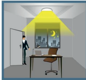
Då det inte är tillräckligt mycket dagsljus i rummet tänds armaturen när det är rörelse i rummet.
