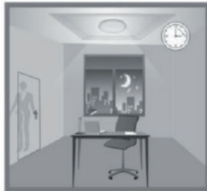
Efter en viss tid uran rörelse i rummet sänks ljusflödet från armaturen
