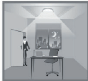
Då det inte är tillräckligt mycket dagsljus i rummet tänds armaturen när det är rörelse i rummet.
