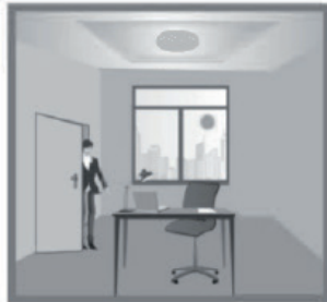
Då det är tillräckligt mycket dagsljus i rummet tänds inte armaturen
